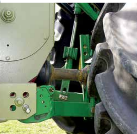
Hydraulischer Seilausstoß mit automatischer Abschaltung beim Seileinzug. Beim Anbau der Winde soll die Stellung der Zapfwelle möglichst waagrecht sein.
