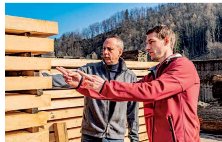
Die Schnittware wird bis zu zehn Jahre unter freiem Himmel gelagert, bevor sie zu hochwertigen Eichenfässern verarbeitet wird. Dabei spielt die Holzqualität eine wichtige Rolle.
